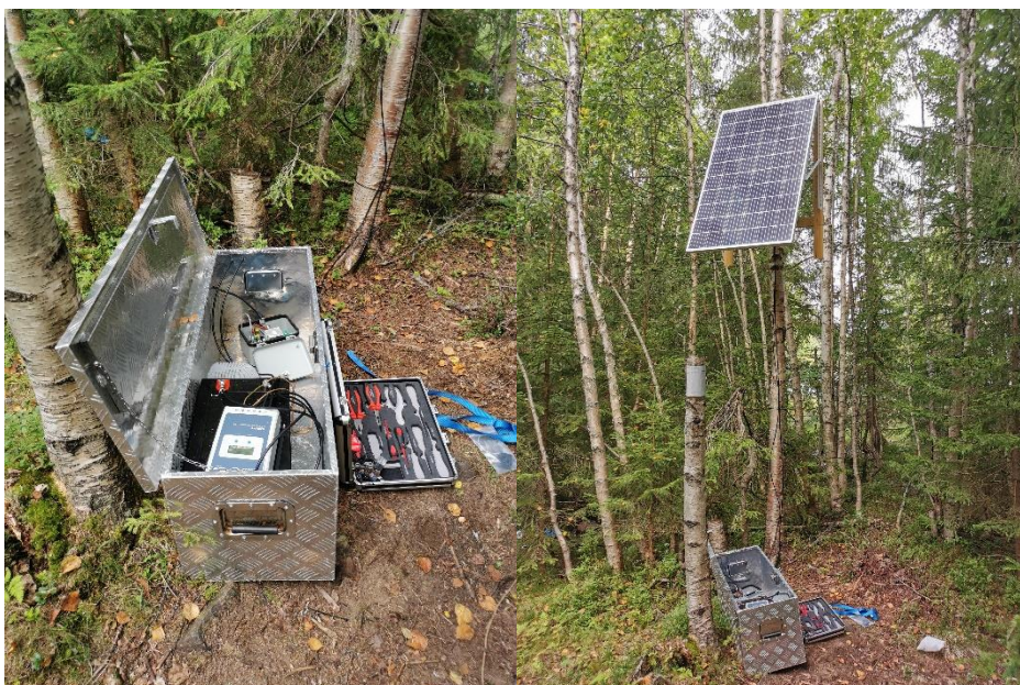
Figur 7 (t.v.): Aluminiumsboks med batteri, PIT-tag-registreringsboks, ladderegulator, solcellepanel-reguleringsboks og avfukter.
