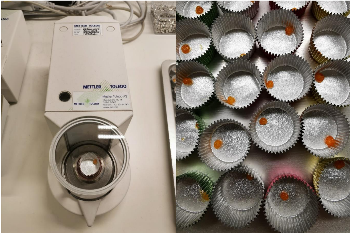
Figur 21 (t.v.): Våt- og tørrvektivveiing av egg i issjokoladeform fra Toppits.
