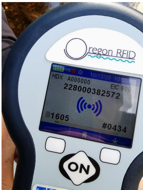
Figur 17: Håndskanner for registrering av unike PIT-nummer.
