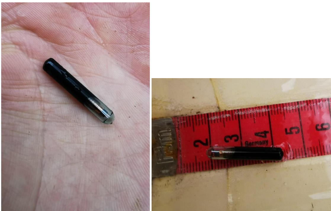
Figur 5 og 6: PIT-merker (Passive Integrated Transponder) av typen half-duplex (HDX).
