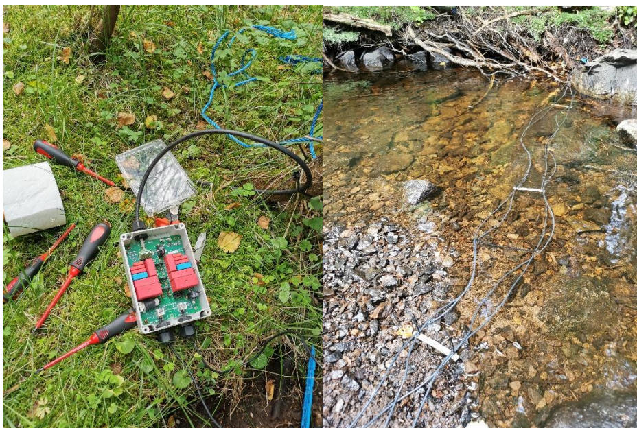
Figur 9 (t.v.): Strømreguleringsboks (Antenna tuner box) som sørger for riktig og jevn strømfrekvens i antennen.
