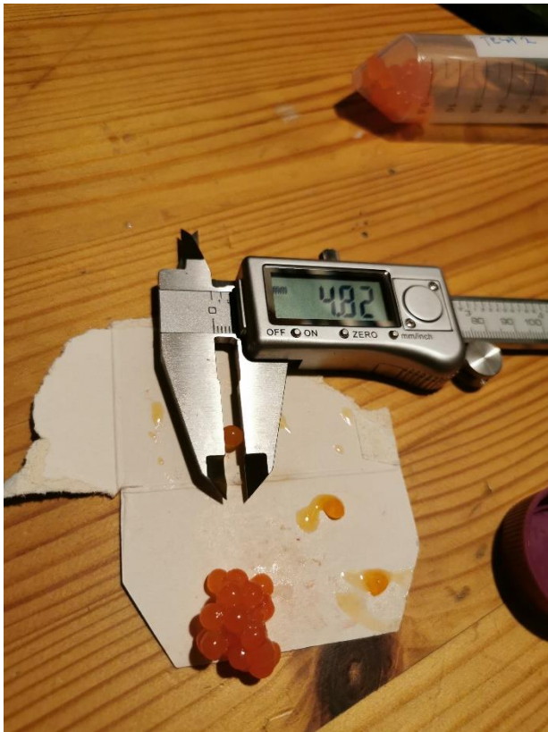
Figur 20: Diamettermål av ørretegg ved hjelp av digitalt skyvelære.
