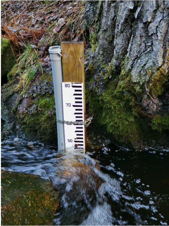
Figur 18: Målestav med påmontert temperatur- og pH-logger i et perforert rør på venstre siden og en trykklogger på høyresiden (under vann).
